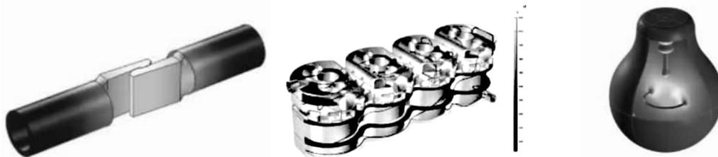
图 5.1 热传导实例示意图 发动机中的强制对流散热 灯泡中的辐射散热
