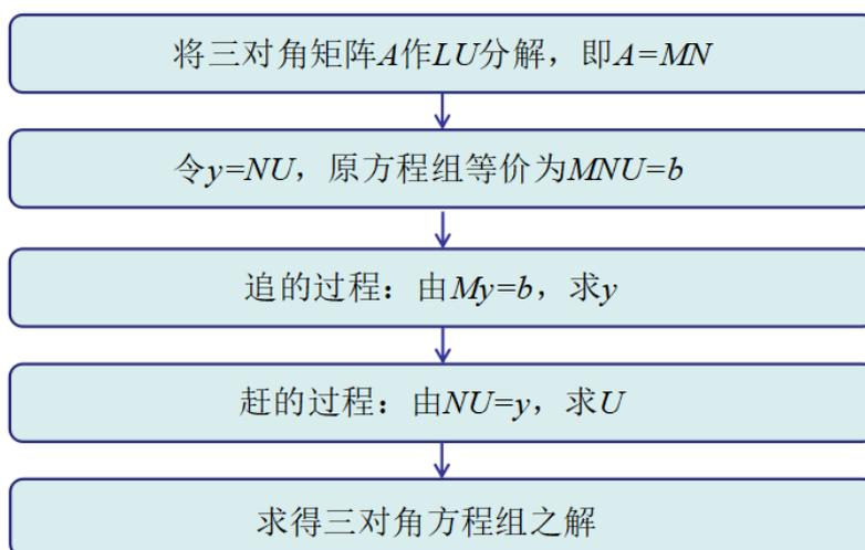
图 11 追赶法求解三对角线性方程组
